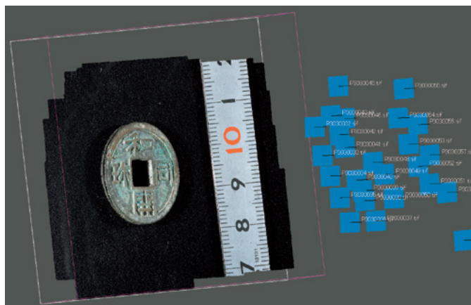
図28 SfM-MVS プログラムによる解析画面 (青い四角形が撮影位置を示す)
