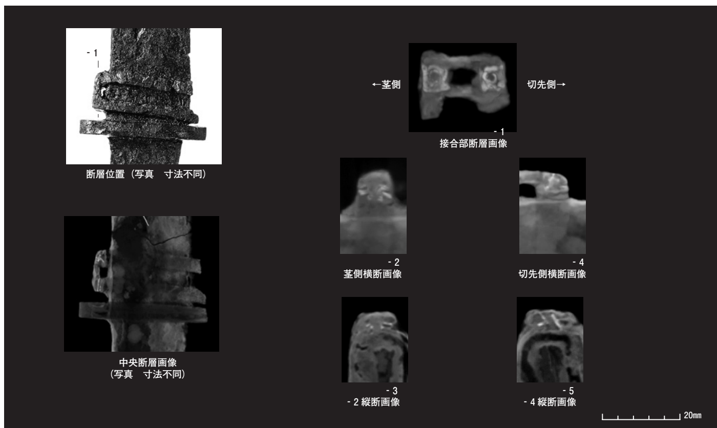
図24 双脚足金具の断層画像
