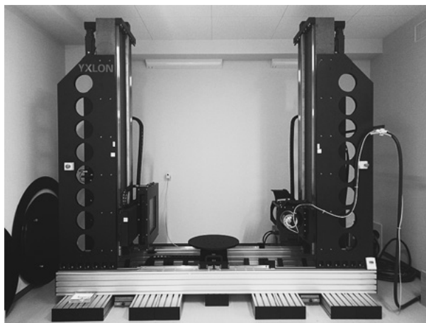
図19 奈良国立博物館設置 X線CTスキャナー
